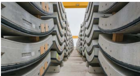
Sieben Tübbinge bilden einen Tübbingring.
