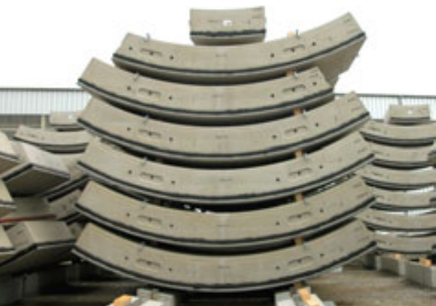
Die maßgefertigten Tübbinge liegen nach der Fertigung auf dem Lagerplatz nahe des Südporthals bereit
