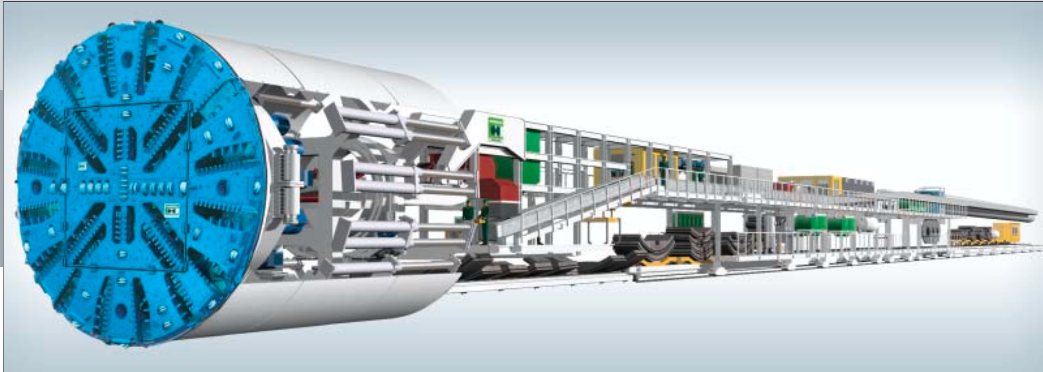
Jeweils rund 200 Meter Länge werden die beiden Tunnelbohrmaschinen aufweisen, die eigens für den Vortrieb und Ausbau des Katzenbergtunnels gebaut werden
