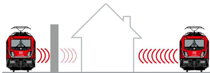
Eine Schallschutzwand bewirkt eine deutlich geringere Schallausbreitung für die Anwohnenden eines Schienenweges.
